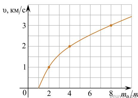
Из графика видно, что полученная Циолковским закономерность может быть кратко сформулирована следующим образом: если скорость истечения газов из сопла двигателя постоянна, то при уменьшении массы ракеты в геометрической прогрессии модуль скорости ракеты возрастает в арифметической прогрессии. Иными словами, если при уменьшении массы ракеты в 2 раза ( $\frac{m_0}{m} = 2$ ) модуль скорости ракеты увеличивается на
